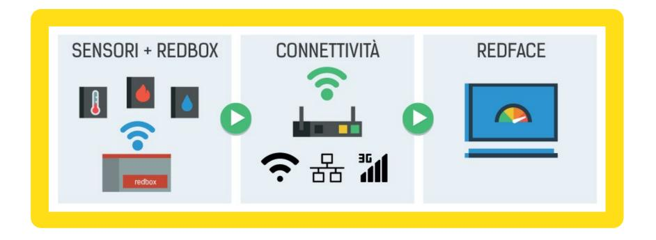
Da sensori che effettuano misurazioni in base al sistema analizzato PLC e microcontrollori che effettuano misurazioni ad intervalli di tempo regolari. Controller (REDBOX) che può interfacciarsi direttamente alla sensoristica oppure ricevere dai PLC e microcontrollori i dati da inviare al server centrale.
